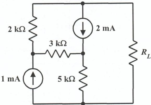
$\text{Req} = 2\text{k}\Omega + 3\text{k}\Omega + 5\text{k}\Omega = 10\text{k}\Omega$
